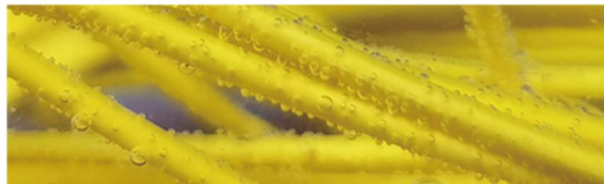
전열관 내의 열선에 전기를 인가할 때 열매체의 온도 상승은 내부 압력의 상승을 유발하고 열매체의 포화온도가 비례하여 증가합니다. 따라서 일반적인 밀폐된 전열 온수관에선 압력 상승에 따른 포화온도의 상승으로 인하여 열매체가 포화온도에 도달할 수 없거나, 포화온도와 전열면의 온도차이가  $5^{\circ}\text{C}$  이하로 형성되어 핵비등현상이 일어나기 어렵습니다.
